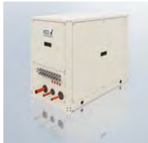
Die Kältemittel-Sammelstation von Panasonic ist schnell und einfach zu installieren. Das in Schutzart IP54 ausgelegte Gehäuse der Sammelstation enthält 5 Kugelventile mit Stellglied, einen 30-l-Kältemittelsammler und die zugehörige Steuerung. Die Klemmen für den Störmelde-Ausgang, die Hochdruck- und Niederdruck-Messwertgeber und die Heißgastemperaturfühler der Außengeräte befinden sich an der Frontseite der Sammelstation, um das Anschließen zu erleichtern.
